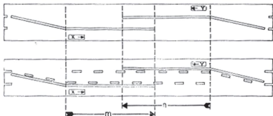
Diagrama 3 - Ejemplo de trazado de marcas sobre una calzada de tres vías en un tramo donde la visibilidad es insuficiente (curva horizontal, subida de una cuesta) o en otros puntos peligrosos.
